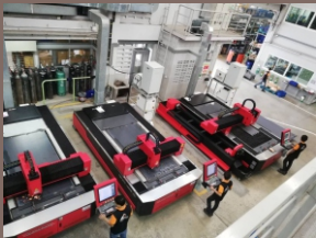
ตัดด้วยไฟเบอร์เลเซอร์CNC
