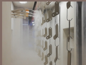
ทำสีด้วยเครื่องพ่นอัตโนมัติ POWDER COAT
